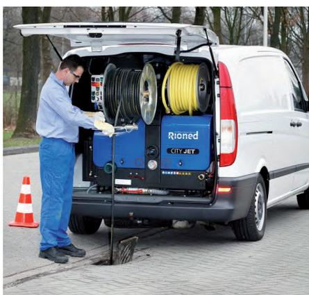
City Jet integrato su mezzo mobile ideale per disotturazione e pulizia di canalizzazioni sino al diametro massimo di 450 mm.
